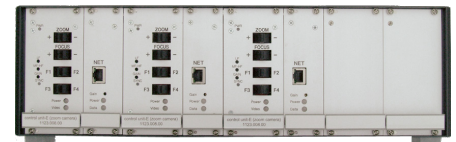
6fach Kamera-Rack mit drei Kamera-Steuer-Einschüben und drei Videosevern bestückt
