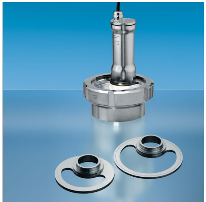
Lumistar Leuchte ESL 53-LED-B, Montage auf Schraub-Schauglas-Armatur nach DIN 11851 oder ähnlich
